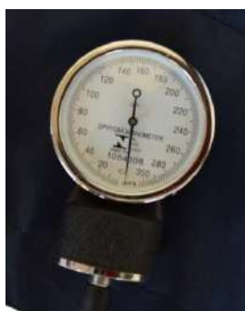
Figura 25.4 – Manômetro (para estar calibrado o ponteiro deve estar sobre o número zero)
