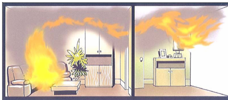
Fonte: Le guide national de référence Explosion de Fumées – Embracement Généralisé Éclair Figura 69 – Línguas de fogo buscando oxigênio no compartimento ao lado
