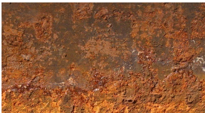
Figura 17 - Material sob ação da ferrugem, que caracteriza uma reação lenta
