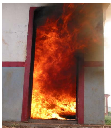
Figura 70 - Exemplo de línguas de fogo - Ensaio na casa de fumaça/CTO - CBMDF
