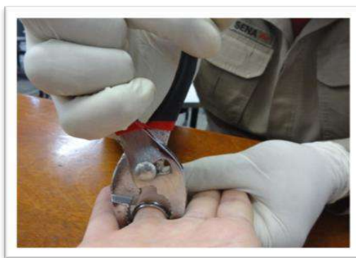
Figura 4.5 – Modificando o formato do anel para forma elíptica com alicate (Fonte: Comissão)
