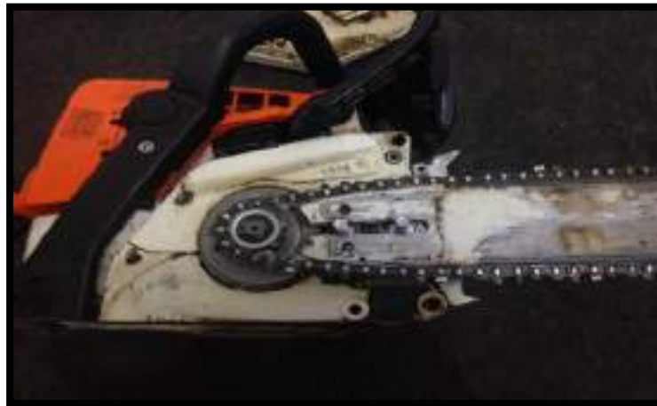
Figura 4.15 – Desmontagem do Sabre (Fonte: Comissão)
