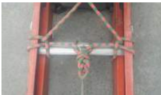
Figura 1.8 – Confeção do nó na escada (Fonte: Comissão)
