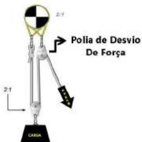
Figura 3.3 - Sistema 2:1 com desvio de força (Fonte: Briggs, 2013)
