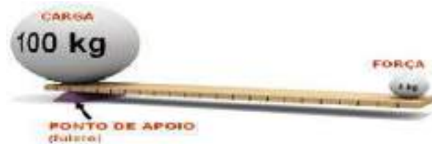
Figura 5.3 - Princípio da alavanca (Fonte: Adaptada de Economipedia. Disponível em: < http://economipedia.com >. Acesso em: 25 mai. 2017)
