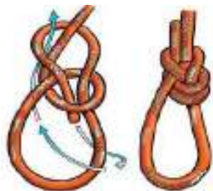
Figura 4.17 – Confeção do nó Lais de Guia com finalização Yosemite (Fonte: Marski, 2013)
