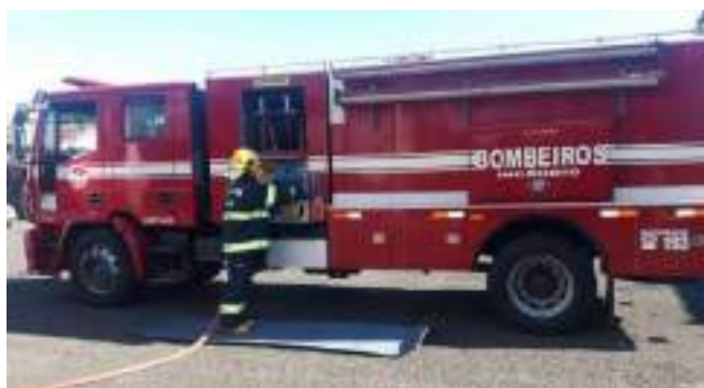
Figura 2.1 – Operador do Corpo de Bombas protegido por esteira de borracha Fonte: (CBMGO)
