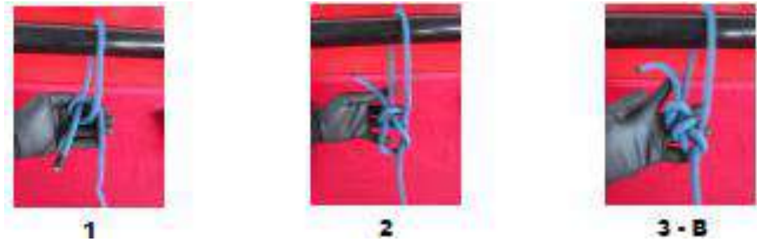
Figura 4.14 – Confeção do nó Lais de Guia (Arrematado por fora) (Fonte: Comissão)
