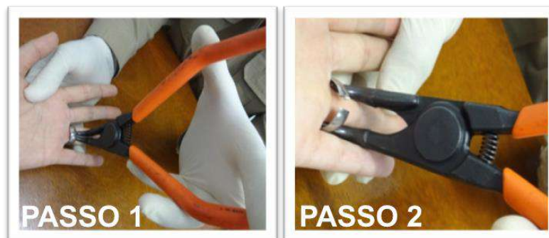
Figura 4.18 – Retirada de anel cortado com o alicate de ação reversa (Fonte: Comissão)
