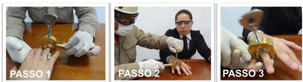
Figura 4.1 – Quebra de anel de carboneto de tungstênio com equipamento específico “quebra anel” (Fonte: Comissão)
