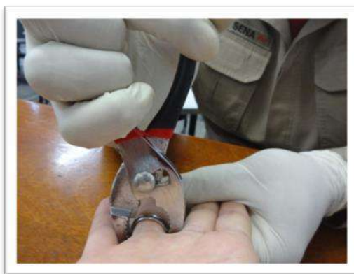
Figura 4.8 – Pressão sobre o anel com alicate para mudar a forma do elíptico (Fonte: Comissão)
