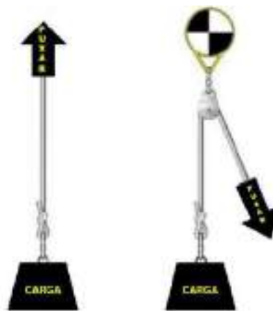
Figura 3.1 - Sistema 1:1. Neste caso a velocidade de subida da carga será a mesma velocidade executada pelo operador. (Fonte: Briggs, 2013)
