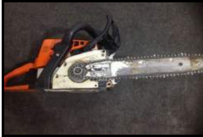
Figura 4.17 – Montagem do Sabre (Fonte: Comissão)
