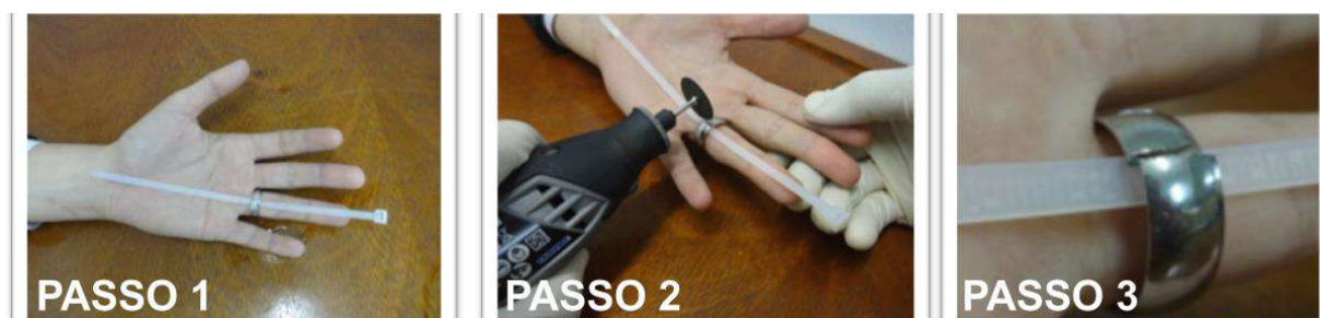
Figura 4.12 – Procedimento de retirada de anel de aço inox com micro retífica usando anteparo de nylon (Fonte: Comissão)
