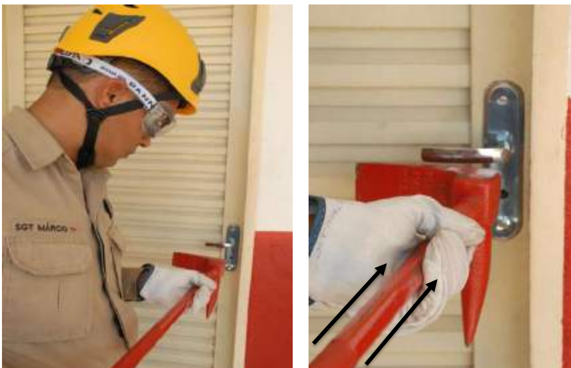
Figura 4.17 – Aplicação do Halligan na Fechadura (Fonte: Comissão)
