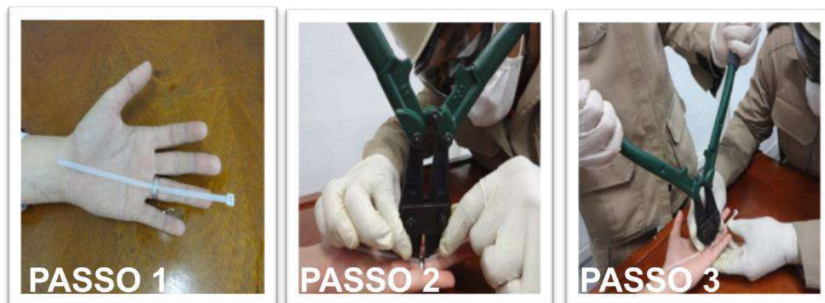
Figura 4.16 – Procedimento de retirada de anel aço inox com corta vergalhão/ corta a frio usando anteparo de nylon (Fonte: Comissão)
