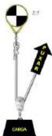
Figura 3.2 - Sistema 2:1 sem polia de desvio de força (Fonte: Briggs, 2013)
