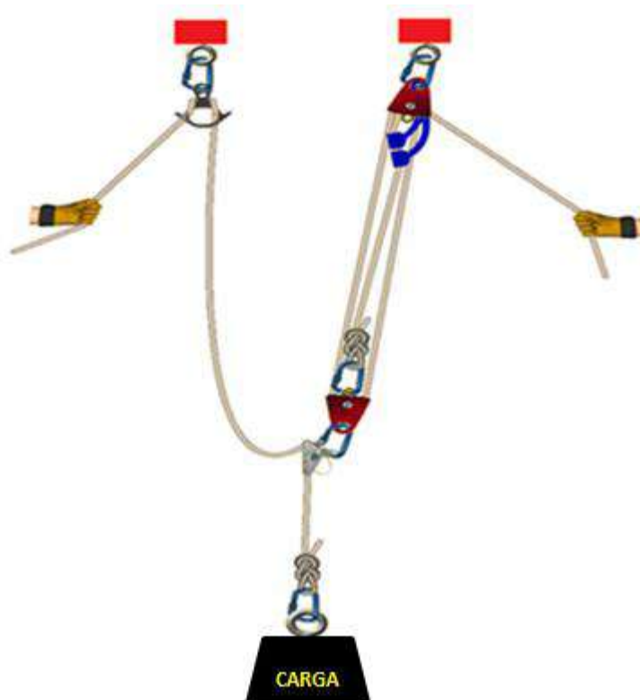
Figura 4.11 – Sistema Simples Independente 4:1, Vertical (Fonte: Salvamento Brasil. Disponível em: < www.salvamentobrasil.com.br >. Acesso em: 15 mar. 2017)
