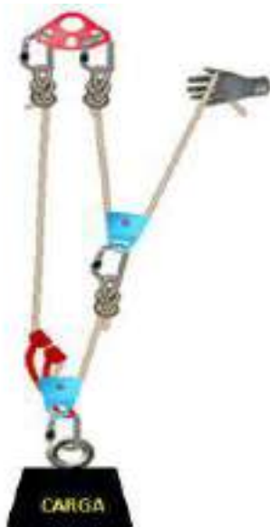
Figura 5.1 – Sistema Composto ou em “talha exponencial” 4:1 (2:1 x 2:1) (Fonte: Minas Adventure)
