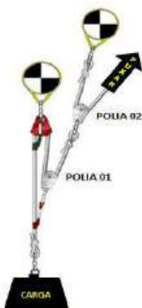
Figura 5.4 – Sistema Composto ou em “talha exponencial” 6:1 (3:1 x 2:1) (Fonte: Briggs, 2013)
