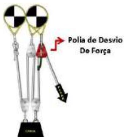
Figura 4.4 – Sistema 4:1 com desvio de força e captura de progresso (Fonte: Briggs, 2013)
