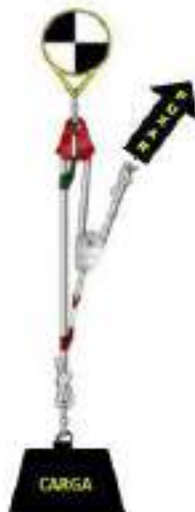
Figura 4.8 – Sistema 3:1 Simples Reduzido Vertical. Nó Prussik em retinida como bloqueador estrutural (vermelho) e captura de progresso (preto) (Fonte: Briggs, 2013)
