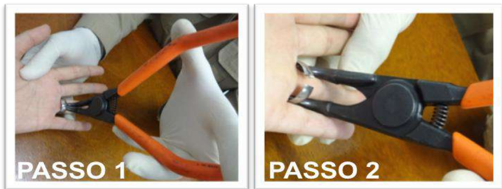
Figura 4.14 – Retirada de anel cortado com o alicate de ação reversa (Fonte: Comissão)
