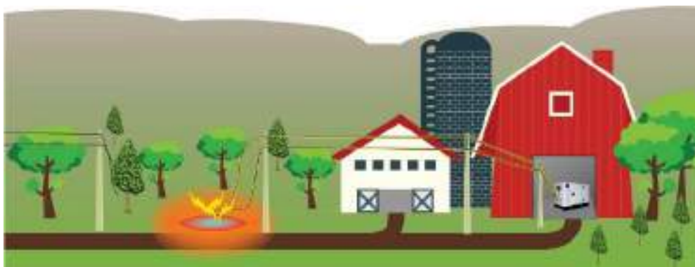
Figura 3.4 – Gerador automático retroalimentando a rede elétrica (Fonte: Comissão)
