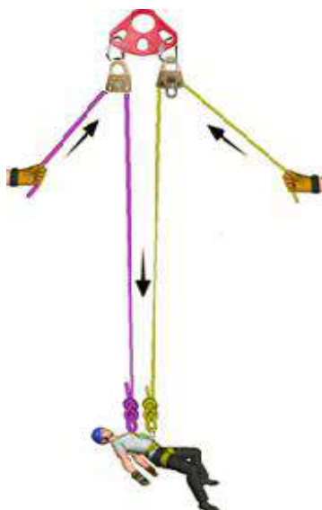
Figura 4.12 – Sistema Simples Dependente 2:1, Vertical (Fonte: Minas Adventure)
