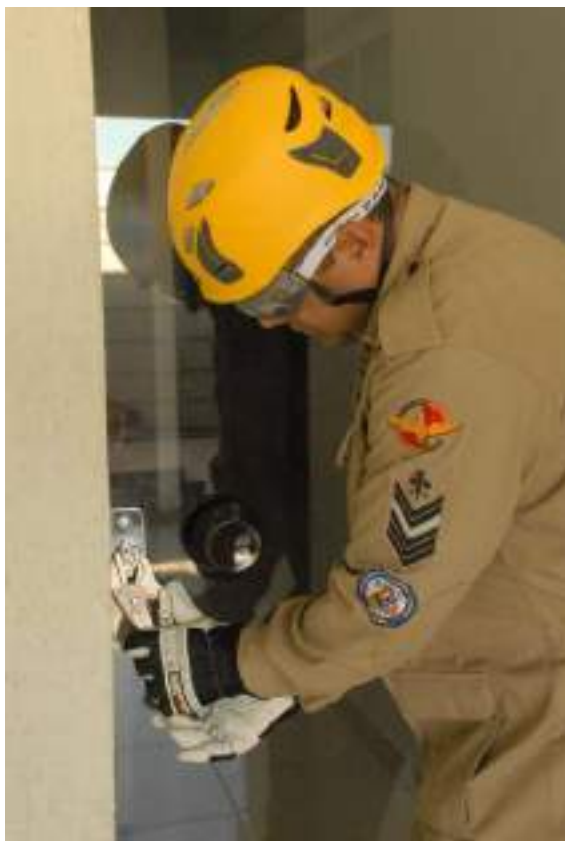
Figura 4.26 – Cilindro exposto (Alicate de pressão em sentido giratório) (Fonte: Comissão)
