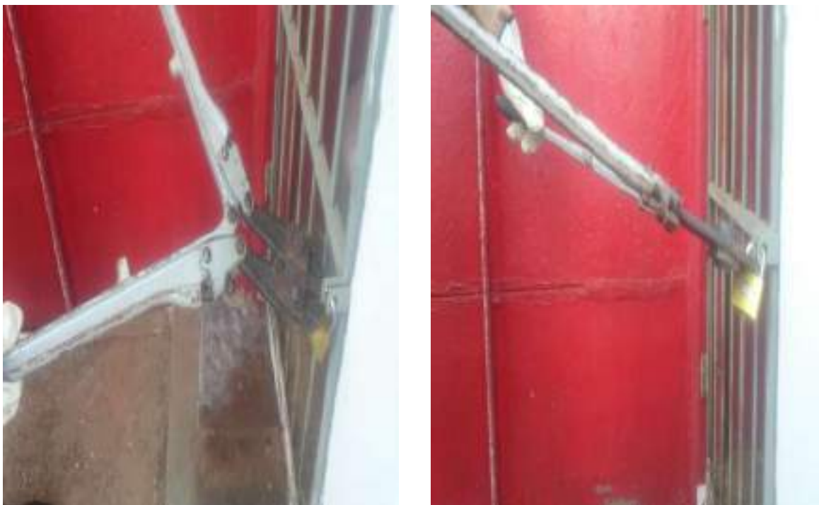
Figura 4.31 – Corte do cadeado com corta a frio (Fonte: Comissão)
