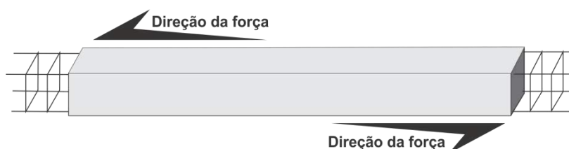
Figura 3.16 – Tensão tração (Fonte: Adaptado de U.S. Department Of Homeland Security, 2011)
