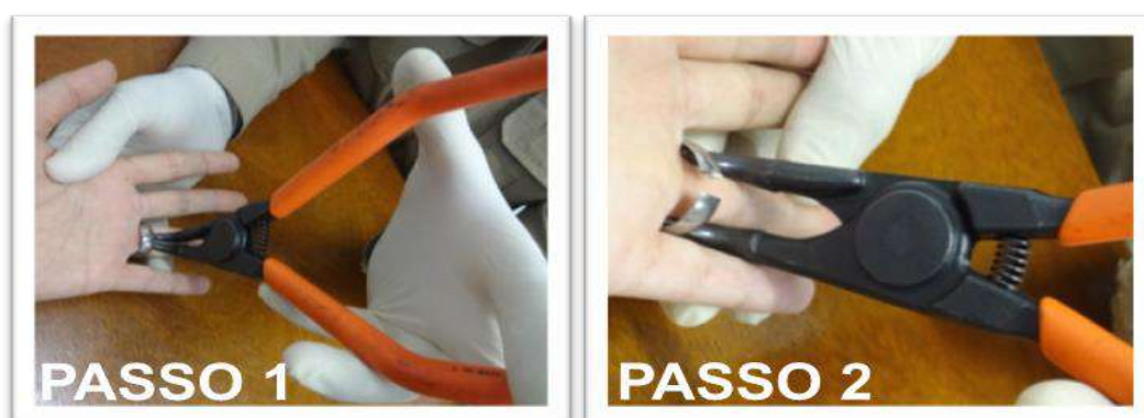
Figura 4.10 – Retirada de anel cortado com o alicate de ação reversa (Fonte: Comissão)
