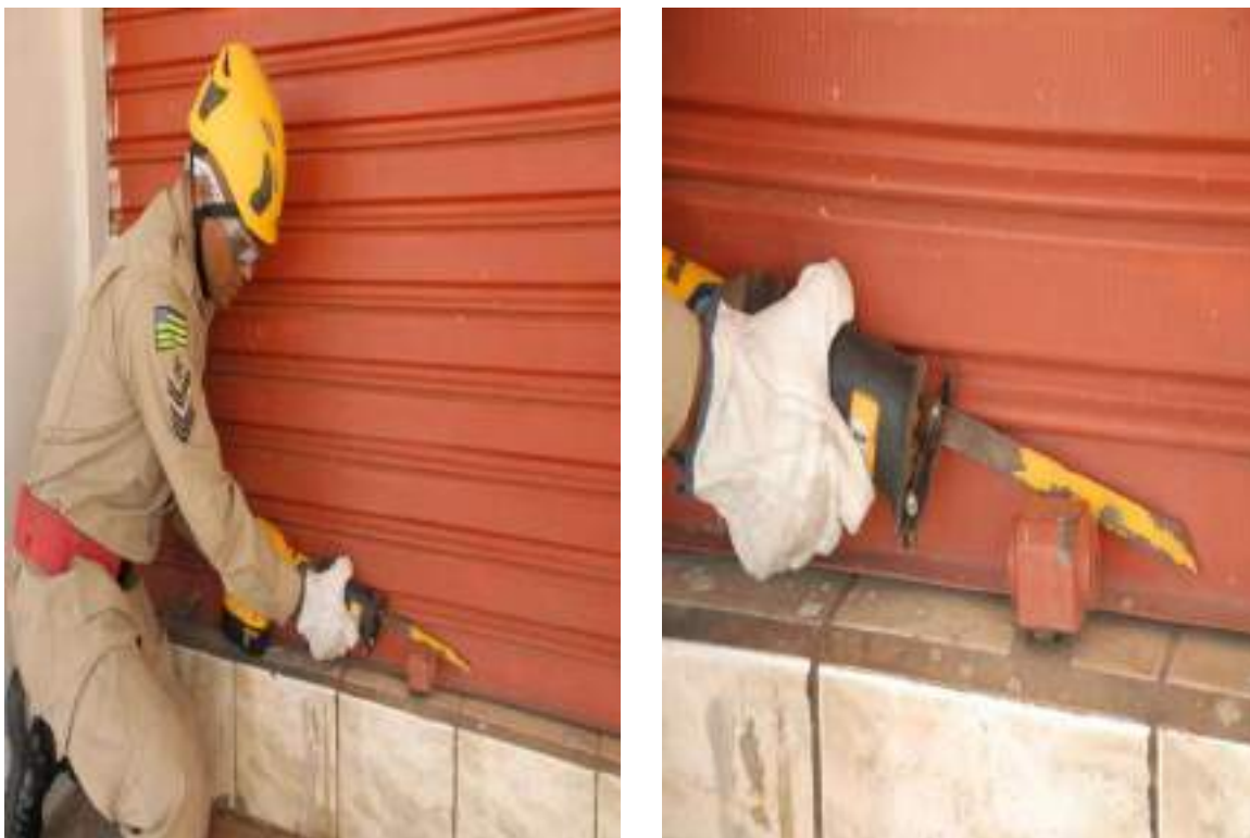
Figura 4.33 - Corte da Fechadura rente a porta com o serra sabre (Fonte: Comissão)
