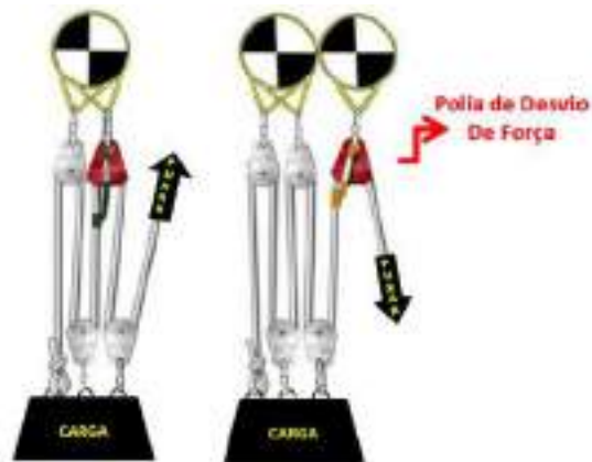
Figura 4.5 – Sistemas 5:1 sem e com polia de desvio de força + captura de progresso (Fonte: Briggs, 2013)
