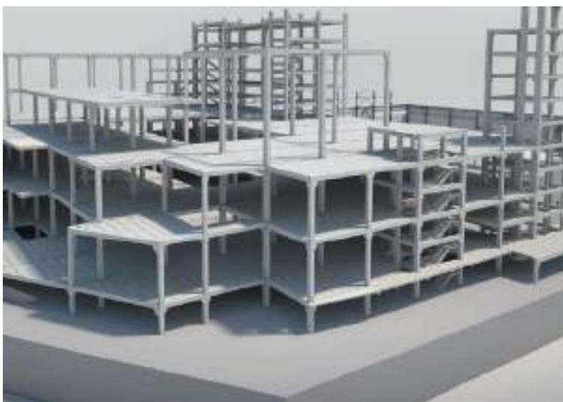
Figura 3.5 – Edificação de estrutura pré-fabricada (Fonte: Leonardi, 2015. Disponível em: < http://www.leonardi.com.br >. Acesso em: 16 abr. 2017.)
