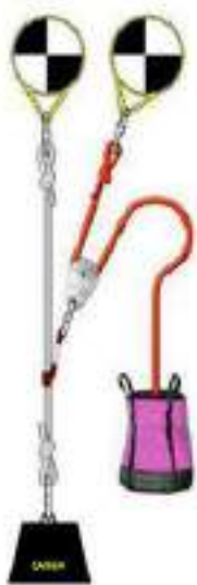
Figura 4.9 – Sistema Simples Independente 2:1, Vertical (Fonte: Briggs, 2013)
