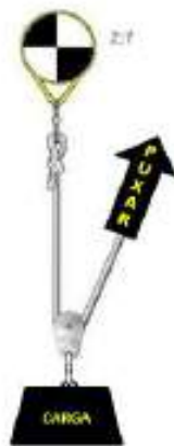
Figura 2.2 – Sistema 2:1 (Fonte: Briggs, 2013)
