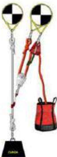
Figura 4.10 – Sistema Simples Independente 3:1, Vertical (Fonte: Briggs, 2013)
