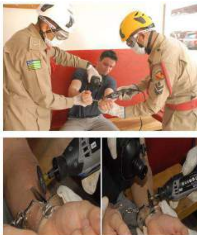
Figura 6.1 – Corte de algema com micro retífica (Fonte: Comissão)
