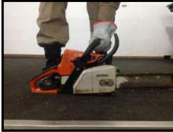
Figura 4.5 – Motosserra presa no Chão (Fonte: Comissão)
