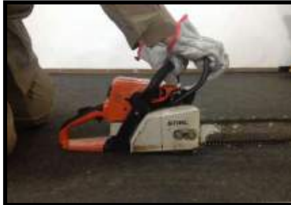
Figura 4.4 - Funcionamento do Freio (Fonte: Comissão)
