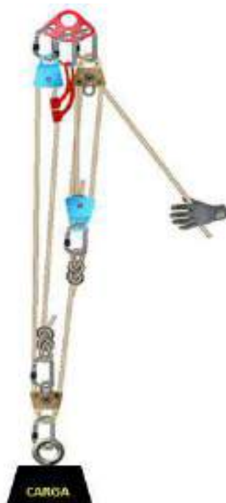
Figura 5.3 – Sistema Composto ou em “talha exponencial” 9:1 (3:1 x 3:1) (Fonte: Minas Adventure)
