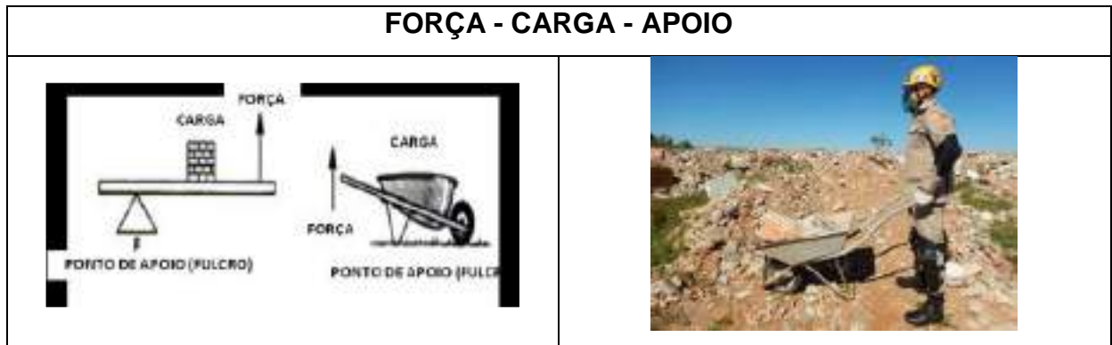
Figura 5.5 - Carga entre o ponto de apoio e a força (Fonte: Comissão)
