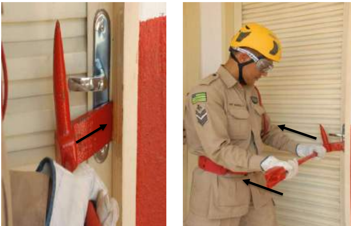
Figura 4.16 – Posicionamento e aplicação do Halligan (Fonte: Autor)
