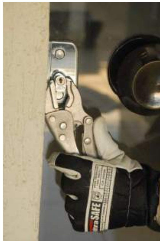
Figura 4.26 – Cilindro exposto (Alicate de pressão em sentido giratório) (Fonte: Comissão)
