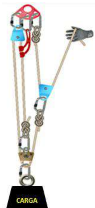
Figura 5.2 – Sistema Composto ou em “talha exponencial” 6:1 (3:1 x 2:1) (Fonte: Minas Adventure)
