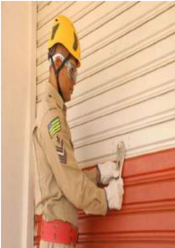
Figura 4.36 – Retirada do cilindro com alicate de pressão (Fonte: Comissão)
