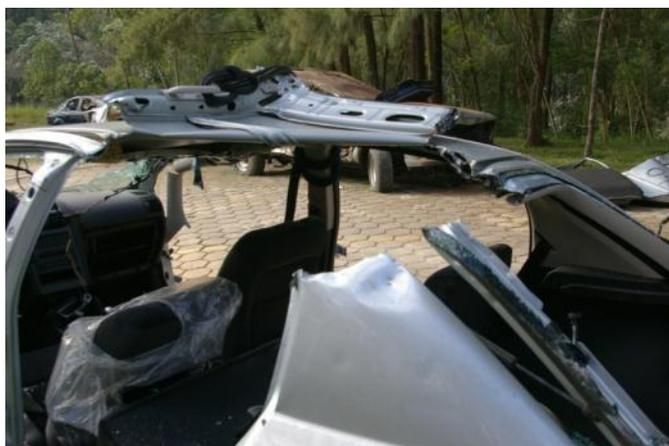
Durante a execução dos cortes nas colunas “B”, caso se utilize ferramenta combinada, deve-se cortar utilizando a técnica do corte em “V”, devido ao formato das lâminas e da coluna. Também se utiliza essa técnica em veículos blindados, para evitar cortar o *overlap*, barra de aço de proteção balística.
