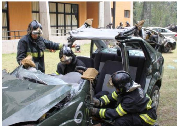
Para a execução dos cortes de alívio no teto, a melhor opção é o uso da serra sabre, pois realiza o corte de modo mais rápido e pode ser utilizada enquanto outro bombeiro utiliza a ferramenta hidráulica.
