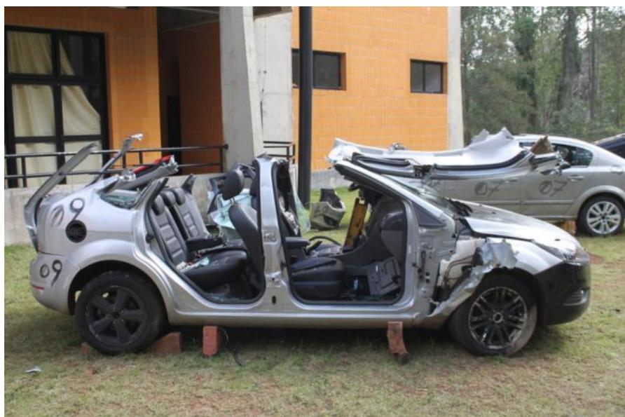
**Lembre-se sempre de verificar a presença de cilindros de air-bags e barras de aço de reforço antes de iniciar os cortes das colunas!**
