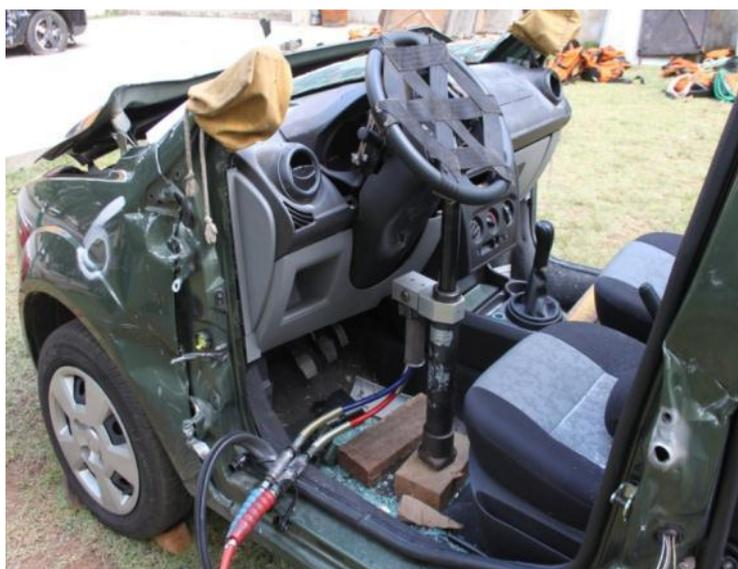
**Na elevação do painel e volante, não se faz o corte de alívio!**
